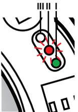
Après le raccordement électrique, le LUXOMAT® PD2/PD4-M-DALI/DSI-1C effectue un cycle d'auto-contrôle de 60 sec. (rouge LED clignotent) et aucun réglage n'est possible durant ce laps de temps.
