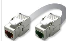
Le signal lumineux sert uniquement au repérage. La LED verte ou rouge indique si le câblage est identique ou différent. Cela n'indique pas si le câblage est conforme à la norme T568A ou B.
