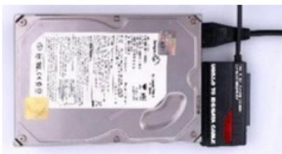
Pour connecter un disque dur IDE 3.5'', utiliser l'adaptateur IDE et connecter l'alimentation comme illustré ci-dessus.
