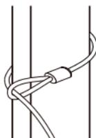
Accrocher le câble de sécurité autour d'un point fixe à l'aide de la boucle situé à l'extrémité du câble
