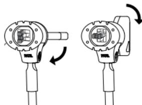
Retirer la clef du bouton de verrouillage pour aligner les crochets (tourner la clef d'1/4 de tour vers la gauche)
