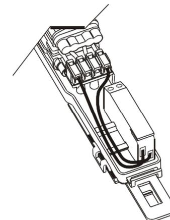
Brancher le câble du porte-fusible sur le bornier.
