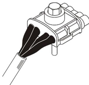
Engager les 4 autres conducteurs dans la partie supérieure du bornier, puis assembler le bornier.
