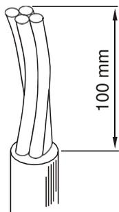
Dénuder les 2 câbles de réseau sur une longueur de 80 à 100 mm.
