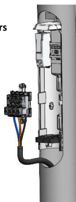
Régler la hauteur du bornier et visser les 2 vis d'accroche
