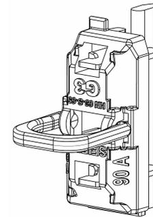
**E** - Engager la barrette de neutre ou le fusible T00 dans le préhenseur jusqu'au maintien mécanique (Translation + clippage).
