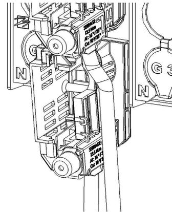
**D** - Mettre en place le capuchon IP 2X sur la vis du connecteur aval.
