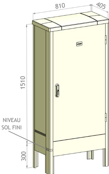
Cette armoire permet l'intégration du matériel de comptage pour réaliser un branchement individuel à puissance surveillée de 37 à 250 kVA :
