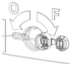
② Introduire le scellé par l'intérieure du fouillot au travers du second trou
