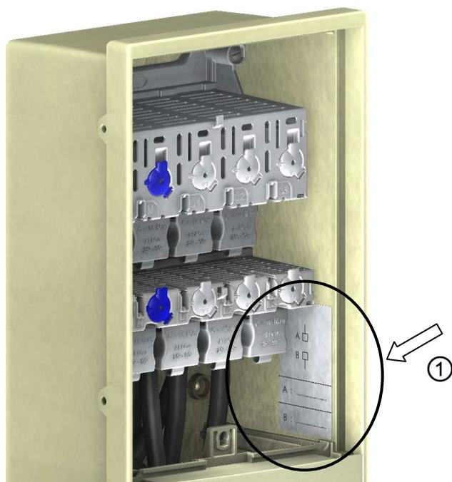
1 – Identifier le raccordement à l'aide de l'étiquette fournie sur le côté droit à l'intérieur de la borne. Effectuer le marquage à l'aide d'un stylo feutre à encre indélébile.
