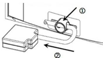
Un canon de cadénassage escamotable ① permet d'installer un cadenas ②. L'ensemble canon/cadenas reste libre en rotation ③
