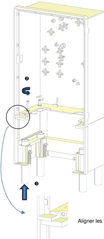
❶ Déboucher les 4 trous du dessous de la cuve du coffret à l'aide d'un foret Ø10 ou à l'aide d'un tournevis et d'un marteau.
