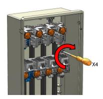
✓ Dans le cas d'une évolution vers un coffret ECP3D, le barreau B ci-dessus doit être déposé et deviendra le barreau C en position basse de l'ECP3D. Le barreau devra être fixé sur des cales. Cette opération pourra être effectuée uniquement avec du matériel SEIFEL. Se reporter à la notice de mise en œuvre du coffret ECP3D.
