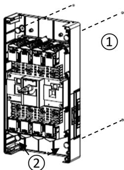
① Vérifier que le support de fixation est plan puis fixer le coffret aux 4 points (200x390).
