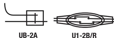
Les connecteurs sont en polycarbonate (non propagateur de la flamme).
