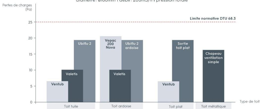
Les pertes de charge sont exprimées en **pression totale** (pression statique + pression dynamique).
