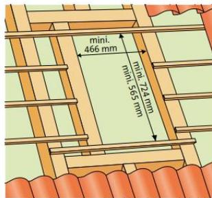
Mettre en œuvre le chevêtre avec lisse haute et lisse basse en respectant les mesures ci-dessus.
