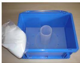
4/ Vider le sac de sulfate au fond de la plaque. Attention, veiller à ne pas en mettre dans le tube.
