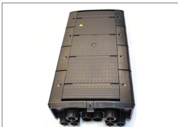
BPEO Boîtier de Protection d'épissures optiques, Point de distribution de câbles de taille 3 pour un câble express et jusqu'à six câbles de dérivation. Organisateur pouvant contenir jusqu'à 48 plateaux d'épissures.
