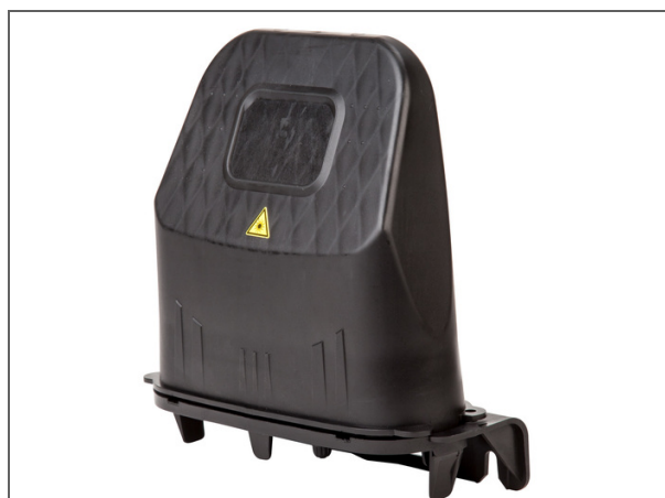
BPEO Boîtier de Protection d'épissures optiques, Point de distribution de fibres de taille 0 avec un câble express et pour un maximum de 12 câbles de dérivation et 2 câbles de dérivation. L'organisateur peut contenir jusqu'à 4 plateaux d'épissures.
