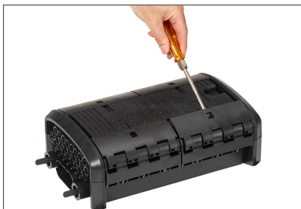
BPEO Boîtier de Protection d'épissures optiques, Point de distribution de câbles de taille 1,5 pouvant accueillir jusqu'à 25 câbles de dérivation et deux câbles de branchement. Organisateur pouvant contenir jusqu'à 12 plateaux d'épissures.
