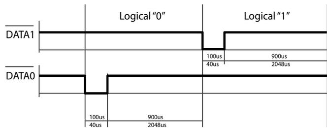
Fréquence de transmission : 1000bits/s
