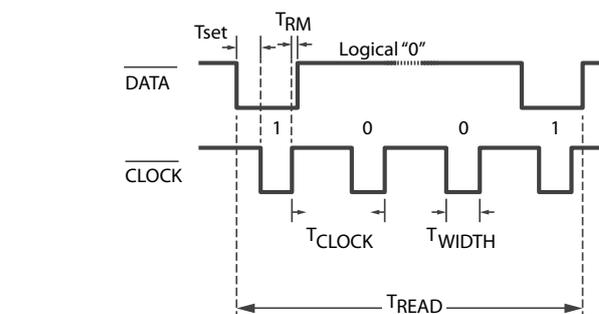
Fréquence de transmission : 1000bits/s
