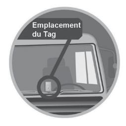
En véhicule lourd, le TAG doit être placé sur la partie inférieure centrale du pare-brise.
