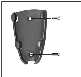
**1** - Fixer le support à l'aide des 2 vis ou avec l'autocollant double face
