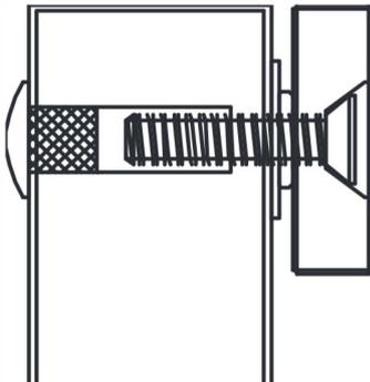
Percer un trou de 8 mm au travers de la porte. Agrandir à 12 mm sur 35 mm de profondeur du côté insert fileté.
