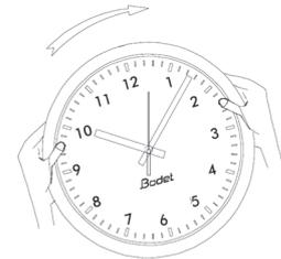
Une fois le support fixé, tourner l'horloge sur celui-ci pour amener l'horloge dans sa position définitive.
