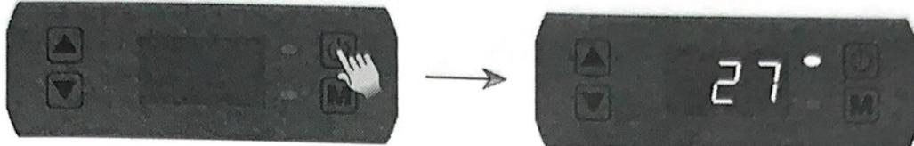
Lorsque la pompe à chaleur est en veille, appuie sur le bouton Marche/Arrêt pour démarrer l'unité. Ensuite la température de l'eau apparaîtra et la pompe à chaleur démarrera automatiquement. Lorsque la température de l'eau d'entrée est inférieure à la température de réglage, l'appareil fonctionne en mode chauffage et l'indicateur de chauffage (rouge) s'active.
