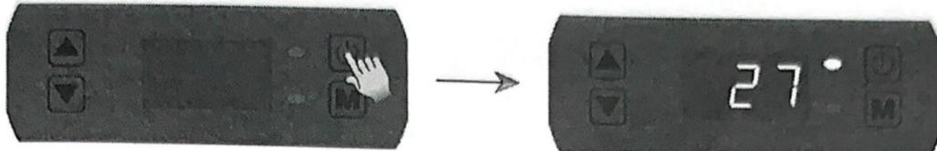
Bei Standby-Betrieb der Wärmepumpe den U-Ein/Aus-Knopf drücken, um das Gerät zu starten. die aktuelle Temperatur des einströmenden Wassers auftritt, und die Wärmepumpe wird automatisch gestartet. Wenn die Temperatur des Eingangswassers unter der Regeltemperatur liegt, arbeitet das Gerät im Heizmodus und die Heizanzeige (rot) ist aktiv.
