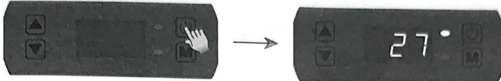
Quando la pompa di calore è in stand-by, premere il pulsante On/Off U per avviare l'unità. La corrente in entrata temperatura dell'acqua apparirà e la pompa di calore si avvierà automaticamente. Quando la temperatura dell'acqua in ingresso è inferiore alla temperatura di regolazione, l'apparecchio funziona in modalità riscaldamento e l'indicatore di riscaldamento (rosso) è attivo.
