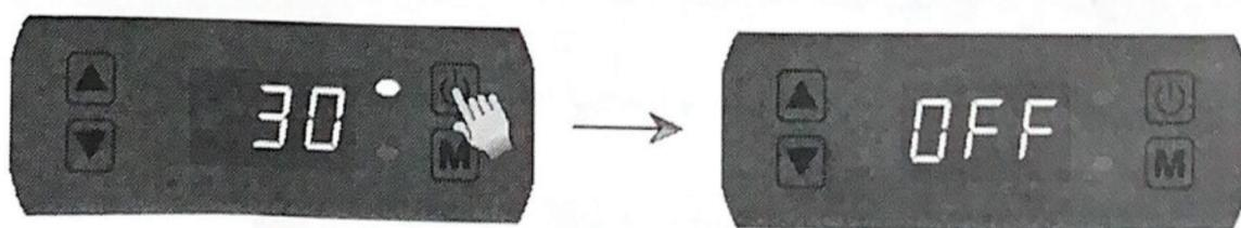
Druk op de aan/uit-knop om de warmtepomp te stoppen. De warmtepomp stopt, maar de ventilator blijft 30 seconden draaien.
