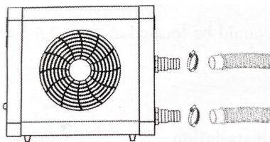
**Anschluss des Kondensatablasskits:**
