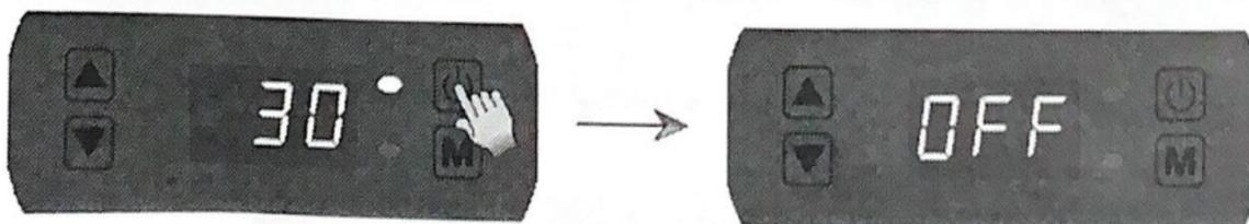
Pulse el botón Encendido/Apagado para detener la bomba de calor. **La bomba de calor se detendrá, pero el ventilador seguirá funcionando durante 30 segundos.**
