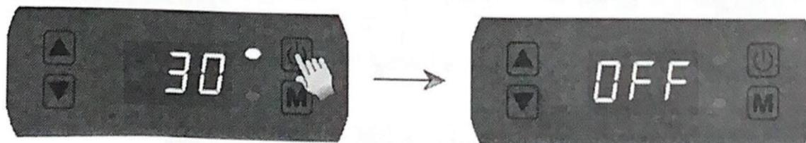
Drücken Sie den Ein/Aus-Knopf, um die Wärmepumpe auszuschalten. **Die Wärmepumpe wird anhalten, aber der Ventilator wird 30 Sekunden weiterlaufen.**
