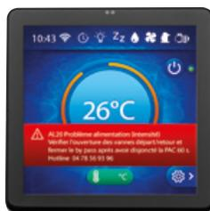
Affichage de l'alarme, diagnostic et solution de résolution avec n° du SAV si nécessaire
