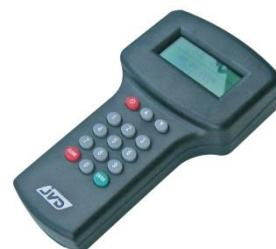
Elle est utilisée pour réalimenter le coffre en énergie en cas de piles vides, pour réaliser des ouvertures en cas de pertes de codes, et pour auditer les 200 dernières opérations sur le coffre.
