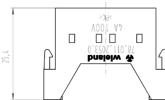
Diese Maße werden bei Abnahme besonders geprüft
