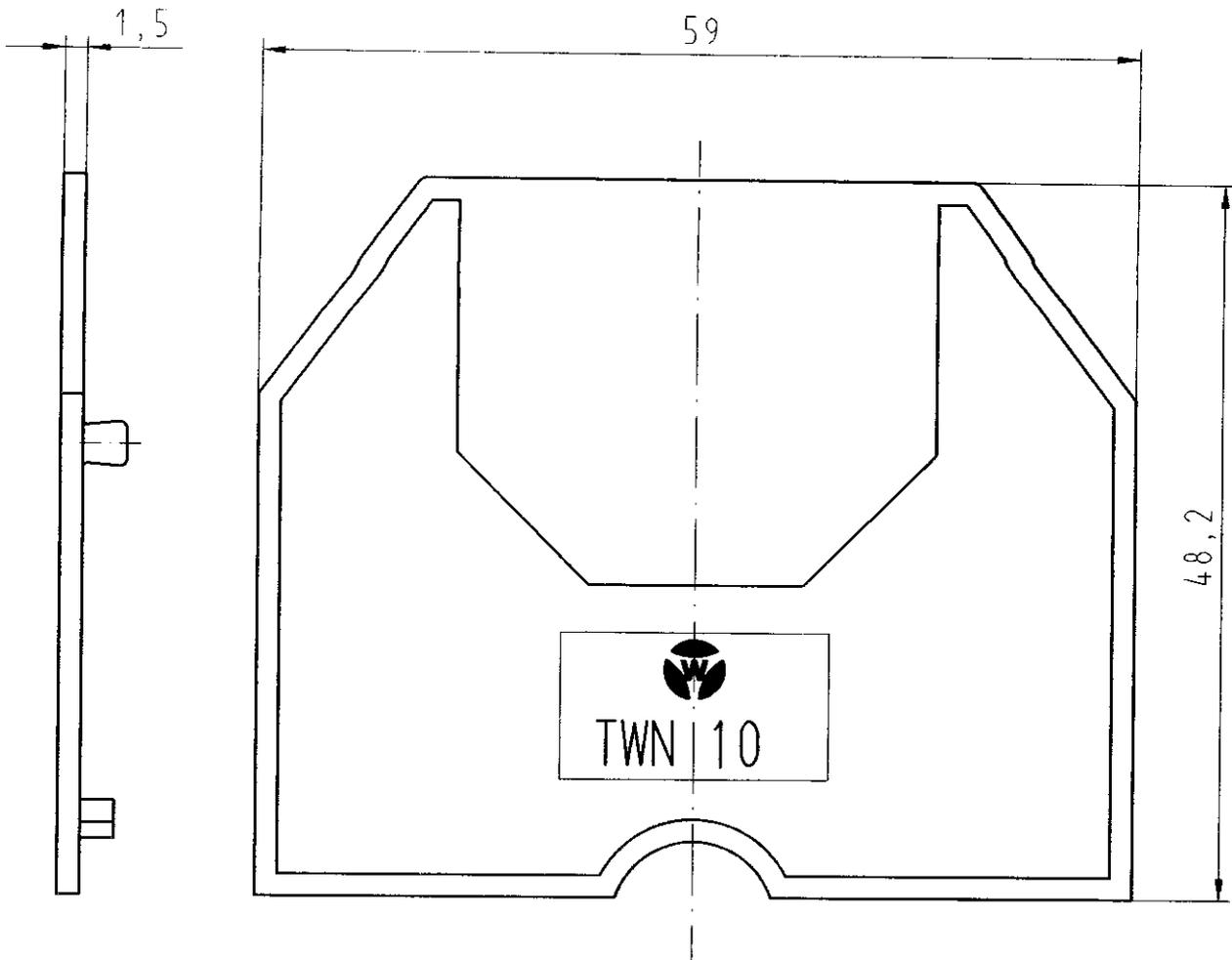
Diese Maße werden bei Abnahme besonders geprüft
