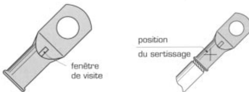
**CONTRÔLE** : il est à effectuer sur machine de traction.
