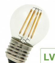
80100037331 LED FIL G45 E27 12V DC 3W (28W) 300lm 827 Clair
