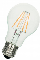
80100040297 LED FIL A60 E27 DIM 5W (45W) 550lm 827 Clair
