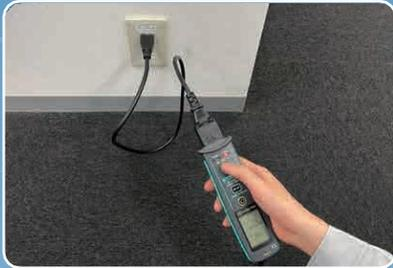
Mesure facile en branchant simplement l'appareil sur une prise de courant et en appuyant sur le bouton de test.
