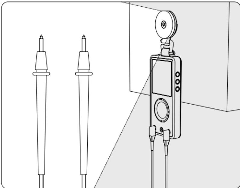
Bevestig de magnetische werklamp aan een (ferro)metalen oppervlak.
