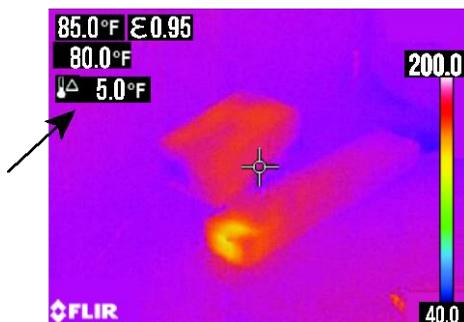
**Fig. 8.4 Exemple de lecture de différentiel de température type K/IGM**
