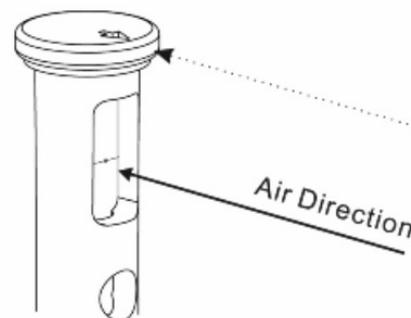
Fig. 6. Comment orienter la sonde à fil chaud
