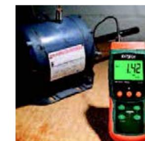
Testez les niveaux de vibration sur les moteurs, les roulements, les ventilateurs, les pompes, les machines rotatives, etc.
