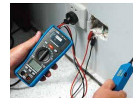
Tester sans assistance le câblage dans l'armoire en connectant simplement les pinces crocodile aux gaines aux prises de contact.
