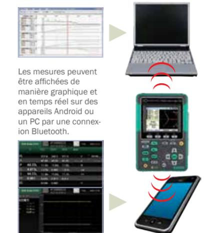
Les mesures peuvent être affichées de manière graphique et en temps réel sur des appareils Android ou un PC par une connexion Bluetooth.
