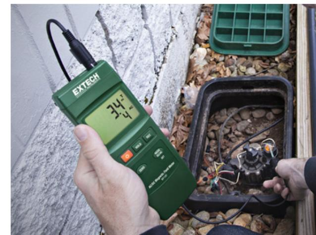
Mesure de la sortie CA champ magnétique du système de relais de sprinkleur
