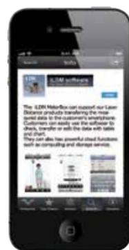
L'utilisation du logiciel du Meterbox iLDM avec un télémètre laser Turbotech/TurbotechPro permet de transférer toutes les mesures vers un smartphone ou une tablette Android et/ou iOS. Par après, le programme peut être utilisé pour vérifier, traiter et envoyer les données vers d'autres appareils.
