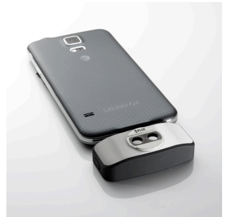
Figure 13.3 2015 : l'accessoire FLIR One pour iPhone et téléphones mobiles Android. Poids : 90 g (3,2 oz.).
