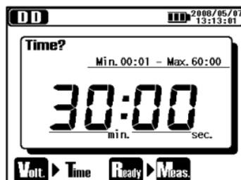
Les paramètres pour la mesure DD sont comme suit. Cf. 6.1.3. et changez les paramétrages.
