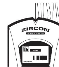
Bewegen Sie nun das Gerät langsam entlang der Oberfläche. Sobald die Kante eines Holzbalkens geortet wird, erscheint das Wort EDGE (Kante) im Display.
