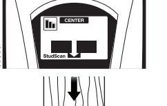
Note: Pour déterminer la nature de l'objet localisé, scannez le point en mode Metal Scan. Dans ce mode, seules les vis de mur sec seront découvertes dans un montant de bois, tandis que les métaux seront indiqués en continu. Pour préciser s'il s'agit d'un montant métallique ou d'un tuyau, se rappeler qu'un montant court le plus souvent du sol au plafond, ce qui n'est pas forcément le cas d'un tuyau.
