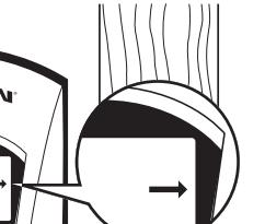
Continuez à faire glisser l'outil. Lorsque le centre d'un objet est détecté, les trois barres sur l'Indicateur de Puissance du Signal, les segments de l'Indicateur de Cible, l'indication CENTER et le Pointeur SpotLite® s'allument tous et le buzzer se fait entendre.
