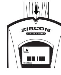
Bei tiefer in dickeren Wänden gelegenen Balken wird die Mitte des gefundenen Balkens mit nur ein oder zwei Säulen auf dem Signalstärkenanzeiger angezeigt, und nur die mittleren Segmente der Zielanzeigesäulen leuchten auf. Falls Sie danach weiterhin keinen Balken orten können, stellen Sie bitte auf den DeepScan®-Modus um. Das Display erleuchtet grün und zeigt Ihnen das Wort "DeepScan".
