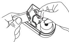
Placez la pile comme indiqué par le diagramme situé à droite. Une bonne mise en place de la pile permettra à l'outil de flotter même en cas d'inondation. Fermez le boîtier avec soin.
