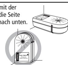
Der Leak Alert™ kann nicht ordnungsgemäß funktionieren, wenn die Kontakte nach oben weisen.
