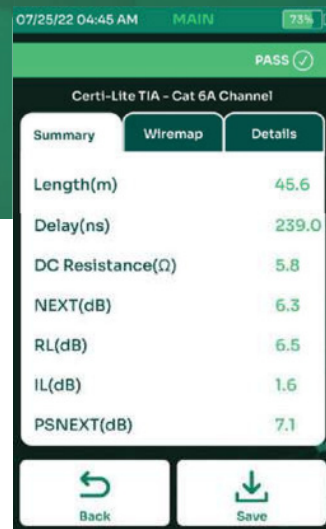
Illustration 4 - Le résultat du Certi-Lite Autotest peut être obtenu avec des identifiants à distance. Cliquez sur l'onglet Détails pour approfondir chaque résultat de test. Les résultats des tests peuvent être stockés dans la mémoire du testeur pour être ensuite téléchargés sur le TestDataPro sur PC inclus, ou immédiatement avec le TestDataPro Cloud inclus via une connexion réseau filaire ou sans fil.
