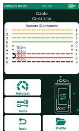
Illustration 5 - Schéma de câblage avec #ID commande à distance identifiée
