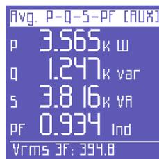
Puissance moyenne et PF (calculés sur la base du temps d'intégration défini. Les valeurs peuvent être remises à zéro) relatifs au canal auxiliaire.
