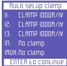
NanoVIP CUBE est capable de détecter quelles pinces de courant (voir note ci-dessous) sont connectées à ses entrées et de se configurer en conséquence, en stockant ces données dans la configuration appropriée.
