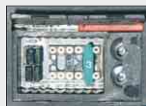
Logement des configureurs
