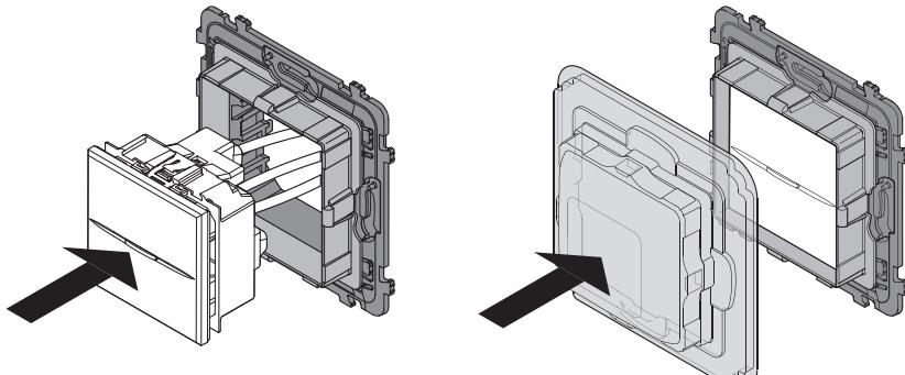
Die Vorrichtungen installieren ohne die orangefarbene Rahmenabdeckung abzunehmen.
