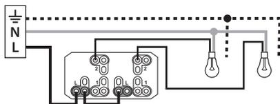
En double va-et-vient, commande de 2 endroits différents
