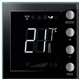
Au bout de quelques secondes, le nouveau réglage est mémorisé et la température mesurée s'affiche (symbole thermomètre allumé).
