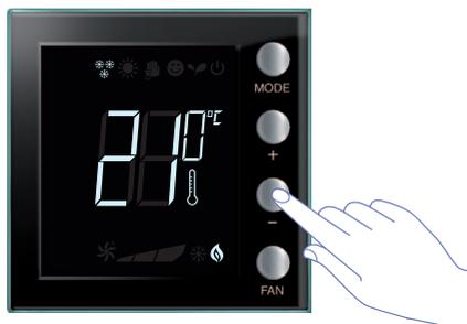
Durant la visualisation de la température en modalité Confort, appuyer sur la touche + ou - pour choisir une des modalités suivantes : Confort ("C" ☺), Confort -1 ("-1" 😊), Confort -2 ("-2" 😊) ou Eco ("E" 🍃).
