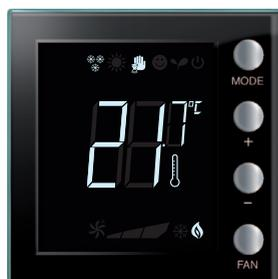
Au bout de quelques secondes, le nouveau réglage est mémorisé et la température mesurée s'affiche. Sur l'exemple, la température programmée est supérieure à la température mesurée : dans ce cas, s'allume également l'indicateur du chauffage en marche
