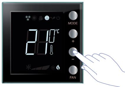
Alors que le thermostat est en modalité Confort, appuyer sur la touche + ou - pour choisir une des modalités suivantes: Confort ("C" 😊), Confort -1 ("-1" 😊), Confort -2 ("-2" 😊).
