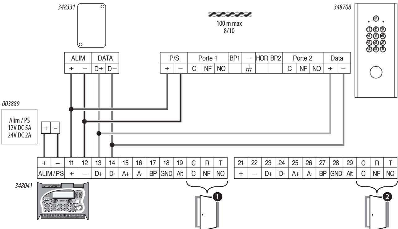
**Câblage d'un portail ou d'une porte équipée d'une gâche**
