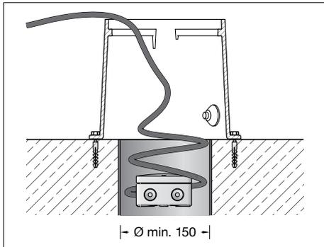
Leuchtengehäuse in Einbaugehäuse setzen, mindestens 10° nach rechts drehen und ausrichten.
