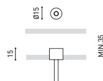
Wire Trimless Accessory est une collection d'accessoires qui permettent d'installer les tendeurs et les câbles des luminaires suspendus d'Arkosligh directement au plafond, sans rosette ni fixation apparente. Ceci permet d'obtenir une application minimaliste et visuellement propre dans l'espace.
